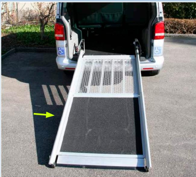
Einen Griff, um die Rampe ganz herunter zu klappen, befindet sich seitlich an der Rampe.
