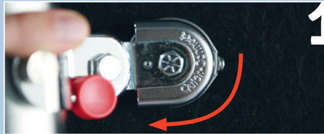
Befestigen Sie die Gurten in einer geraden Linie zu den Retraktoren so, dass bei einem abrupten Zug nur am massiefen Rahmen des Rollstuhls gezogen wird.
