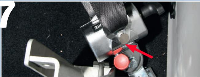
Die Gurte kann ganz leicht in den Retraktor eingerastet werden.
