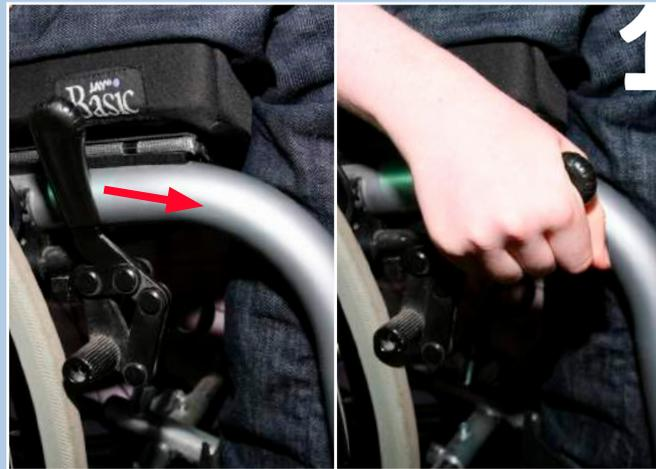
Ziehen Sie die hinteren beiden Gurten aus dem Retraktor und befestigen Sie diese am FESTEN Rahmen des Rollstuhls, nicht an den Rädern!
