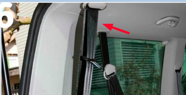
Benutzen Sie zum Angurten der Person die dafür extra montierte Gurte im hinteren Teil des Fahrzeuges.
