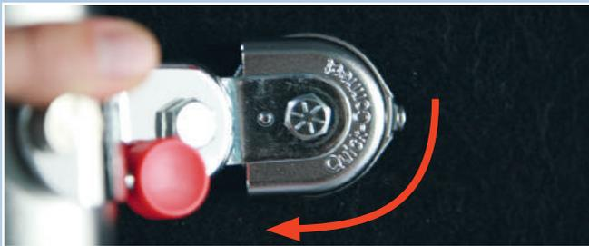
Drehen Sie die Halterung so, dass der Retraktor durch den Nippel gesichert ist.
