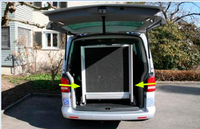
Je nach Rampenmodell muss die Rampe vor dem Ausklappen, wie auf Bild 2 beschrieben, links und rechts gelöst werden.
